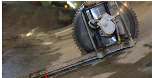
Verwendung bei unebenen Böden auch ohne Distanzstück möglich, z.B. Tunnel
