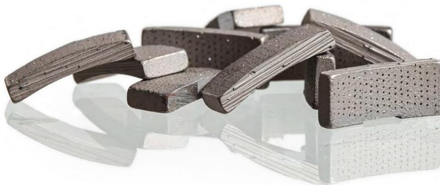
Das AX9-Segment besteht durch präzise, dreidimensionale Symmetrie der Diamantkornverteilung im Trägermaterial. Dies führt zu einer kontinuierlichen Abnutzung des Segmentes und optimiert somit Standzeit und Schnittgeschwindigkeit.
